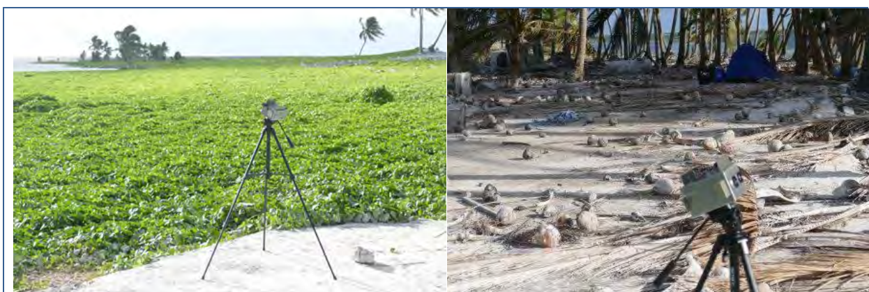
Fig. 33 - Capteur d'aérosols construit par l'équipe de recherche Gepasud de l'UPF avec GPS intégré.
