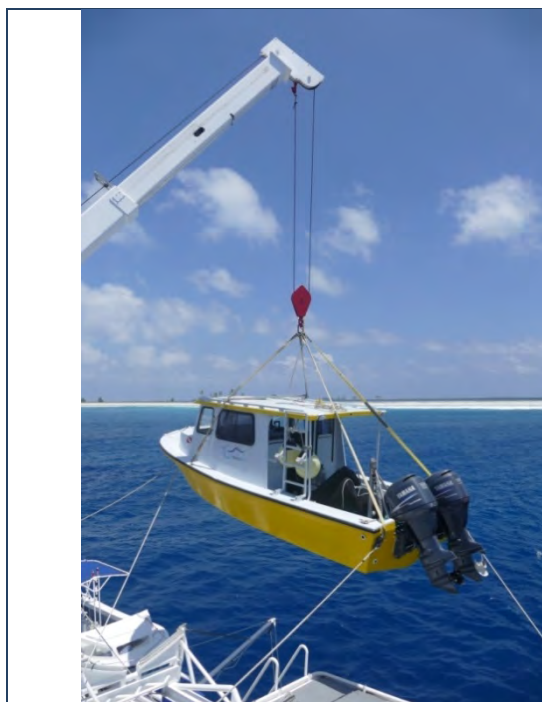
Fig. 7 - "Panga" = bateau au Costa Rica; 2 moteurs de 115CV, 4 personnes, utilisé pour touer le sous-marin et assurer une surveillance de zone.
