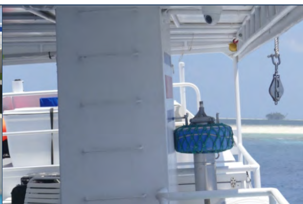
Fig. 4 - Pont supérieur : Balise ou « drift » (bleue) émettrice utilisée en cas de mauvaise visibilité. Jetée à l'eau elle dérive (drift) avec le courant et la suivre permet de retrouver le matériel ou le plongeurs perdu. Elles sont utilisées par les senneurs pour suivre leurs filets.
