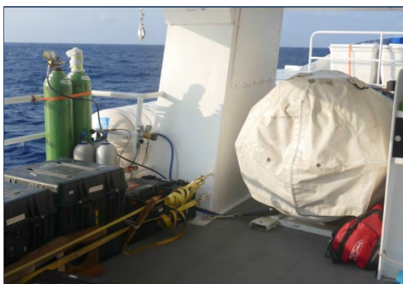
Fig. 3- La chambre de décompression (sous la bâche blanche) et son équipement de bouteilles d'oxygène sur le pont supérieur de l'Argo.
